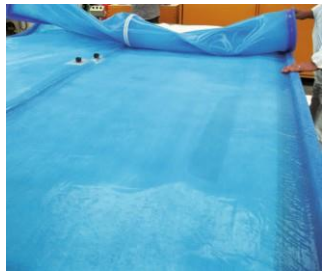
2.2 Abdecken der faserverstärkten Form wiederverwendbarer Vakuumbutel
