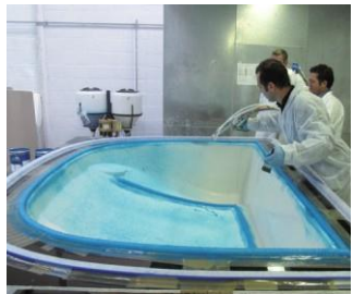
1.2 Aufsprühen von ELASTOSIL® C 1200
